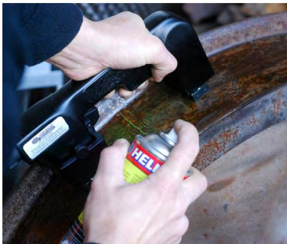
Электромагнит UM15 в стандартном исполнении оснащен трехзвенными гибкими полюсами. За счет этого межполюсное расстояние может устанавливаться в пределах от 95 до 250 мм.
