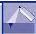
Капиллярный метод неразрушающего контроля основан на капиллярном проникновении индикаторной жидкости (пенетранта) в поверхностные дефекты (трещины, поры и пр.) с последующей регистрацией индикаторных следов визуальным способом или с помощью преобразователя. Метод капиллярного контроля позволяет обнаруживать поверхностные дефекты с раскрытием до тысячных долей миллиметра ( $\mu\text{m}$ ) независимо от вида, материала и конфигурации поверхности.
