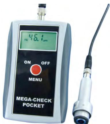
**MEGA-CHECK Pocket FE** оборудован магнитоиндуктивным зондом и служит для измерения толщины изолирующих (лак, краска, пластмасса, резина, керамика) и гальванических покрытий (за исключением никеля) на железных и стальных поверхностях.
