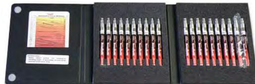
Набор также содержит информацию в отношении правильного определения температуры при сварке, термообработке, (высокотемпературной) пайке и других технологических операциях при металлообработке.
