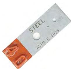
Пенетрометры из железа и легированной стали применяются для всех ферритовых и аустенитных сталей. Свинцовые цифры на образце обозначают номер пенетрометра, который также соответствует толщине образца в тысячных долях дюйма. Каждый образец имеет три отверстия, диаметр которых равен 4x, 1x или 2x-кратной толщине образца. Однако наименьшие диаметры не должны быть менее 0,04 – 0,01 – 0,02 дюйма, поэтому отверстия соответствующего пенетрометра отличаются, начиная с номера 12.
