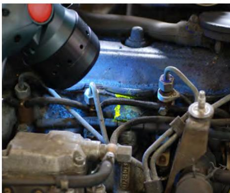
*Регистрация утечки в двигателе с помощью флуоресцентного концентрата Н 800*
